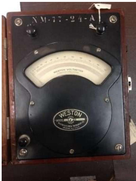
Fig. 10 Voltímetro vuelto a ensamblar
