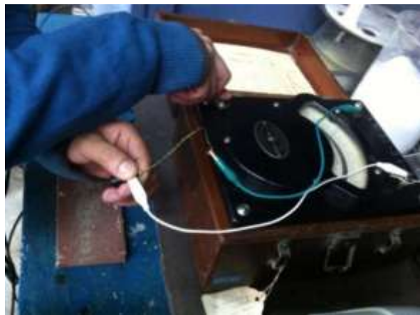
Fig. 8 Prueba con voltímetro Weston (CA)
